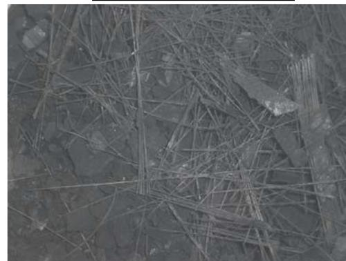
※廃タイヤを油化実験装置で、熱分解した後の再生物です。
